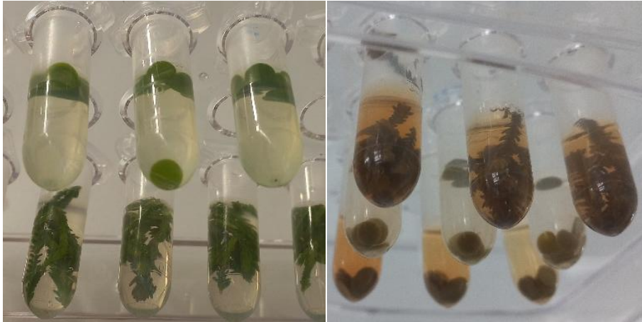
Abb. 4: Proben nach der Temperaturexposition bei 45 °C (links) und 99 °C (rechts).
